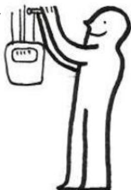
2) Gasmessgerät Stand kontrollieren und notieren.
